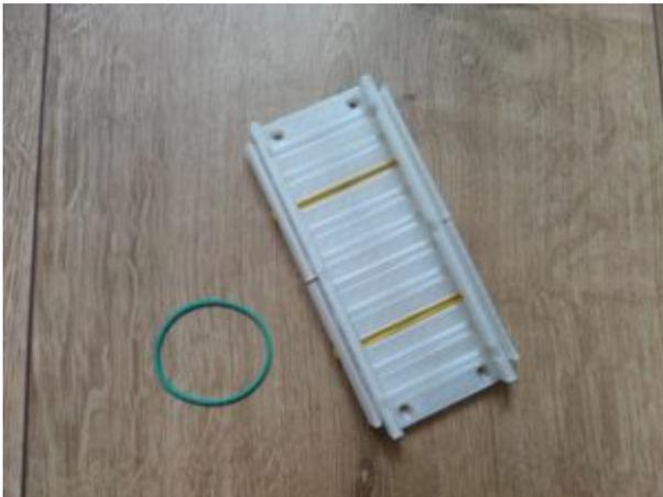
Die Basis muss einmal gedruckt werden, die Einschübe vier Mal. Ideal, um den Arduino, Pi, Breadboard und Co. stabil zu platzieren.
