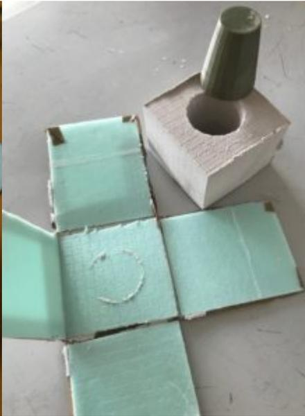
Das Ding (Becher) wird als Patrize verwendet. Es wird in den Formkasten geklebt und der Formkasten wird mit Gips ausgegossen. Nach dem Trocknen des Gipses wird das Ding (Becher) entfernt. Die so entstandene Matrize wird für das Ausgießen mit Flüssigton verwendet. So können mehrere Tongefäße in der Form des Dinges (Bechers) gegossen werden.
