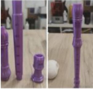
Diese spielbare Blockflöte besteht aus drei Teilen und kann in einem Durchgang ohne Supports gedruckt werden. Für beste Ergebnisse mit „Fiber Force Woodforce Filament“ drucken.
