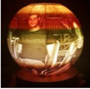
Bei einer „3D-Druck Lithophane“ wird eine Bilddatei in ein 3D-Modell umgewandelt. Dabei werden hellere Farben dünner und dunklere Farben dicker abgebildet. Wird der 3D-Druck im Gegenlicht dargestellt, entsteht eine Darstellung des Bildes. Auf diese Art und Weise kann man beispielsweise einen Lampenschirm erstellen.
